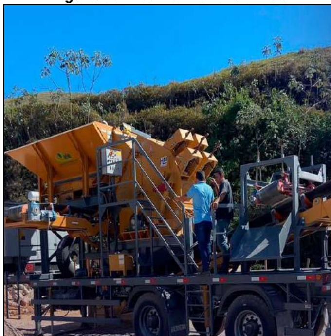
Figura 50 – Usina móvel de RCC
